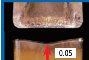
* 工件加工 800 个后的比较照片
